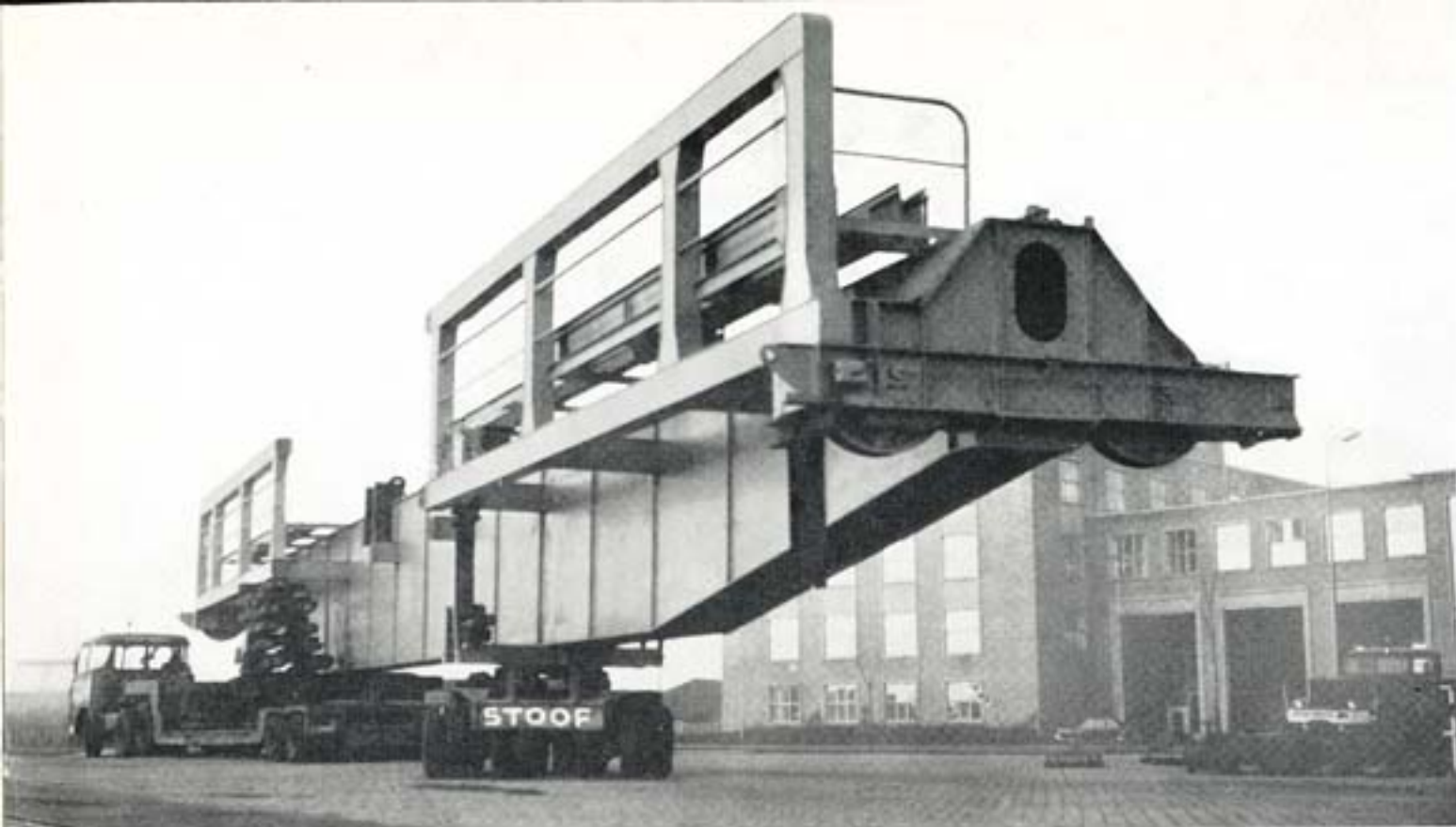
Transport van een kraanligger. Transport de flèche de grue. Transport of an overhead crane traveller. Transport eines Kranträgers.
